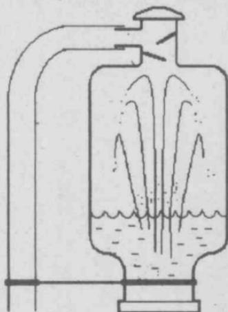
Alternativement, des bidons de dégazage du type suivant pourront être utilisés :
