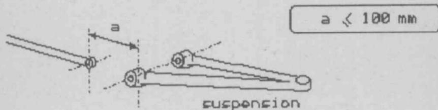
En dehors de ces deux points, cette barre ne doit pas posséder d'ancrage sur la coque ou les éléments mécaniques.
