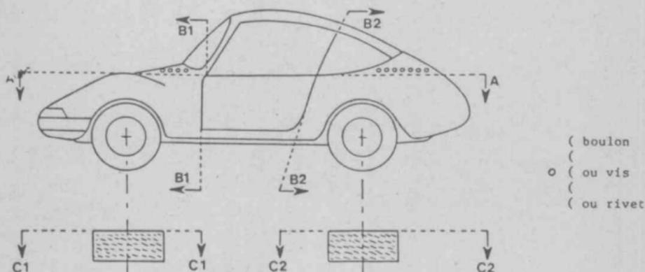
**Aile avant :** partie définie par la face intérieure de la roue complète de la voiture standard (C1/C1) et le bord le plus bas de la/des vitres latérales (A/A) et le bord avant de la porte avant (B1/B1).
