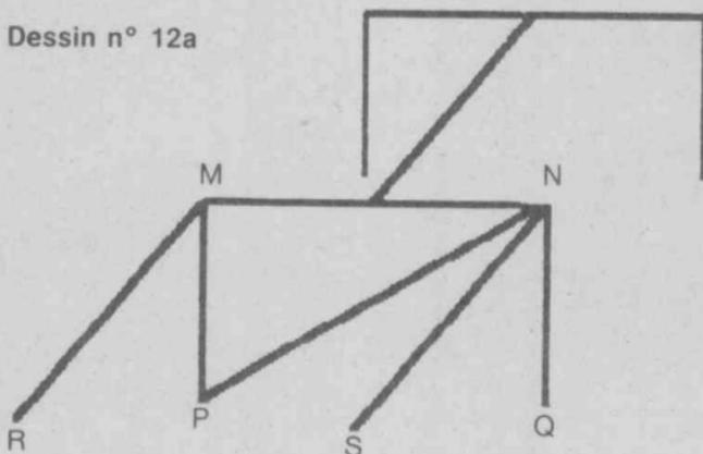
Les différentes variantes de diagonales autorisées sont MQ, MS, NP, NR. Les arceaux de sécurité seront garnis de mousse anti-chocs ininflammable.
