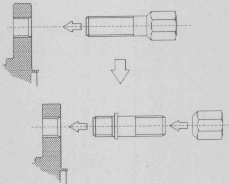
Le changement de fixations de roues par boulons en fixations par goujons et écrous pourra se faire à condition de respecter le nombre de points d'attache et le diamètre des parties filetées, comme figuré ci-dessus.
