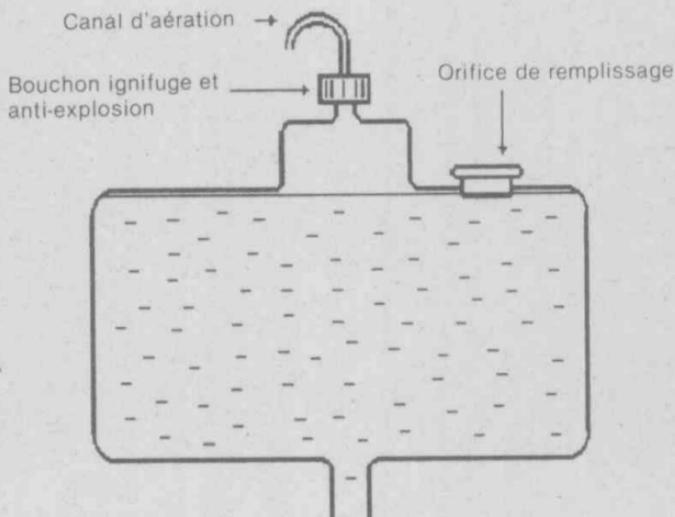
Toutes les parties métalliques du système de ravitaillement à partir de l'accouplement au-dessus du débitmètre jusqu'au réservoir et son support doivent être connectés électriquement à la terre.
