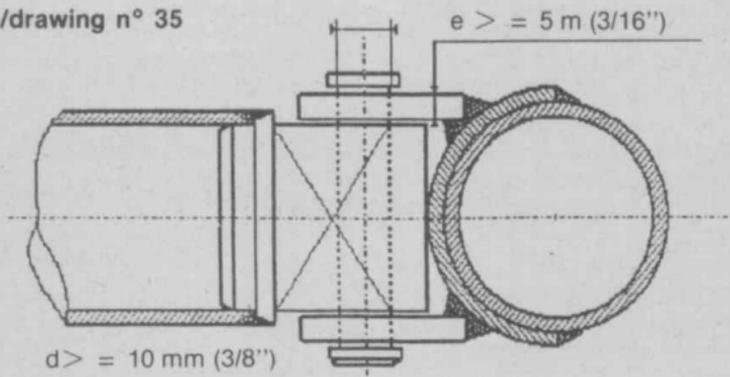
Connexion interdite pour la construction de l'arceau principal (voir Art. 8.1.4.) mais utilisable pour attacher sur cette construction.
