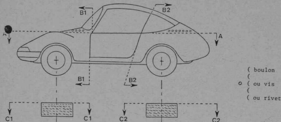
**Aile avant :** partie définie par la face intérieure de la roue complète de la voiture standard (C1/C1) et le bord le plus bas de la/des vitres latérales (A/A) et le bord arrière de la porte arrière (B1/B1).
