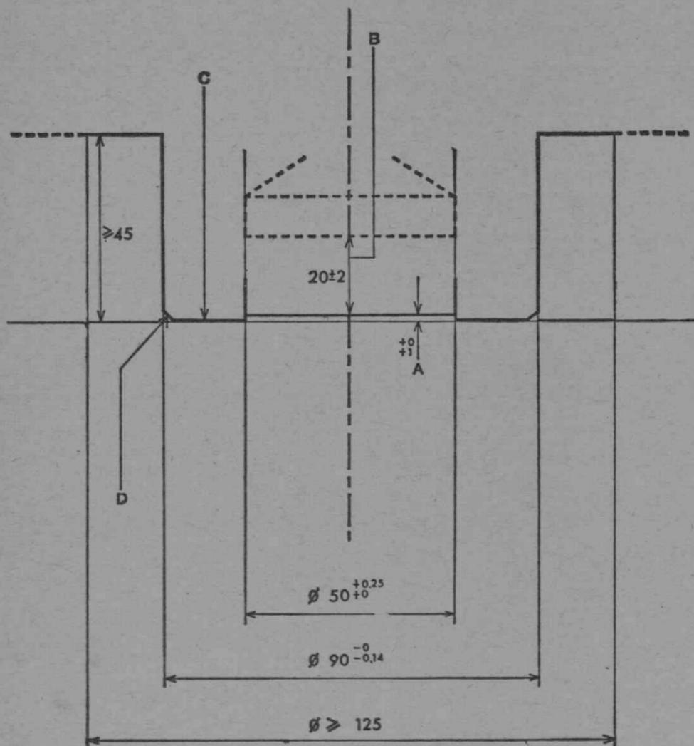
**Orifice de remplissage standardisé pour voitures/Standardised car fuel filler**
